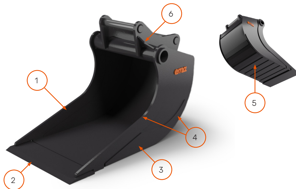
1. Lägre sidor 2. Skär Brinell Borox 500 3. Lång botten 4. Slep och slitskydd Hardox® 450 5. Ribbad botten Hardox® 450 6. Förstärkt vid fäste VIKTIGT: Bilden visar ett exempel på hur det kan se ut på en viss modell, variationer på andra produktmodeller kan förekomma. Alla produkter är inte godkända enligt Hardox® in My Body. Fråga oss om ni vill veta mer.
