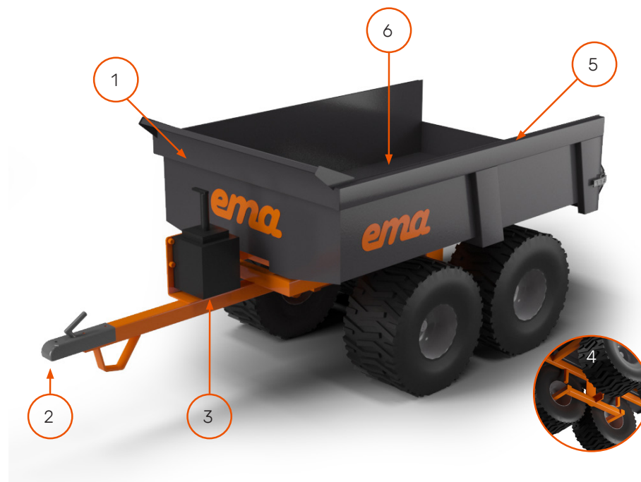
1. Kraftig skyddskeps 2. Ledad dragkula 3. Hydraulisk tipp via pump 4. Kraftig pendelboggi 5. Kraftig bakläm 6. Kraftig flakkonstruktion
