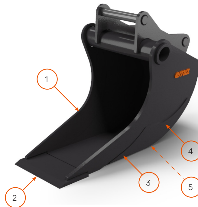
1. Uttagna sidor 2. Skär 500 Brinell Borox 3. Lång botten 4. Slitskydd på sidor, gavel, botten & slitribbor Hardox® 450 5. Slitribbor undertill (Heavy Duty) VIKTIGT: Bilden visar ett exempel på hur det kan se ut på en viss modell, variationer på andra produktmodeller kan förekomma. Alla produkter är inte godkända enligt Hardox® in My Body. Fråga oss om ni vill veta mer.
