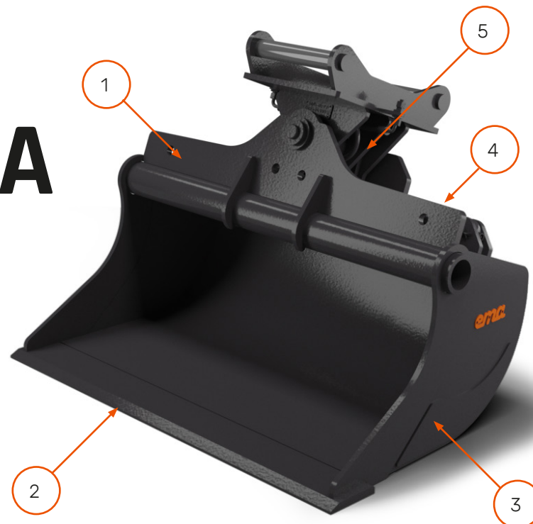
1. Rasskydd 2. Skär 500 Brinell Borox 3. Slitskydd på sidorna och botten Hardox® 450 4. Lättåtkomliga smörjpunkter 5. Stark och robust midja VIKTIGT: Bilden visar ett exempel på hur det kan se ut på en viss modell, variationer på andra produktmodeller kan förekomma. Alla produkter är inte godkända enligt Hardox® in My Body. Fråga oss om ni vill veta mer.
