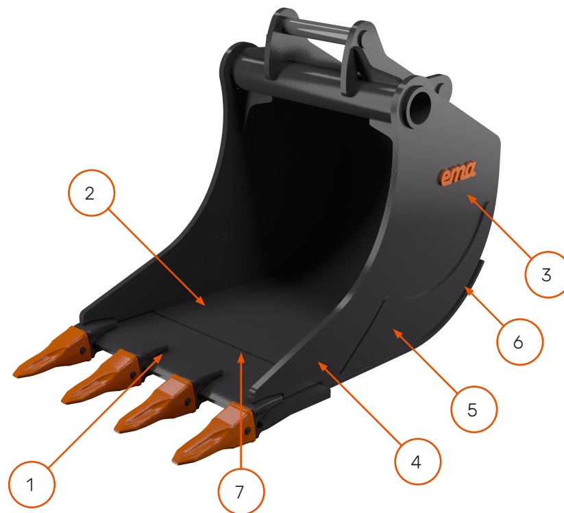
1. Skär 500 Brinell Borox 2. Botten Hardox® 450 3. Sida S355 4. Gavel fram Hardox® 450 5. Slitskydd sida Hardox® 450 6. Slitribbor Hardox® 450 7. "CAT-tandsystem" VIKTIGT: Bilden visar ett exempel på hur det kan se ut på en viss modell, variationer på andra produktmodeller kan förekomma. Alla produkter är inte godkända enligt Hardox® in My Body. Fråga oss om ni vill veta mer.
